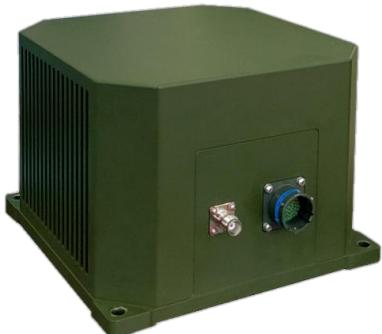
RIG600 型捷联式组合导航系统是一种捷联式惯性组合导航系统。系统采用高精度光纤陀螺和石英加计组成的惯性测量单元和三轴磁传感器，依靠高精度的光纤陀螺仪完成自主对准、捷联解算，给出载体的运动参数，包括载体的位置信息（经度、纬度和高度）、角度信息（航向角、俯仰角与横滚角）和三维角速率、三维线加速度信息。惯导系统借助卡尔曼滤波器，以 GPS 输出的位置和速度信息作为滤波器的观测量，对导航解算参数误差和陀螺误差进行修正，保证在动态环境下和长工作时间的可靠性和测量精度。
