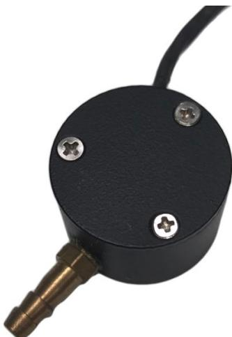
RAS-3 型是 RAS-2 型气压高度计的小型化设计，用于测量海拔高度的气压高度计。选用高精度压力传感器，采用高性能 MCU 对检测数据进行分析、处理、计算，并在全工作温度范围（-50℃～+85℃）对检测信号进行温度补偿，最终得到的高度信号经过 RS422/RS232（可选）接口输出。产品具有数字式输出、精度高、适应温度范围宽、互换性强、年稳定性好、体积小、功耗低、抗潮湿、抗冲击、抗振动性能好的特点。应用于汽车高度测量仪、海拔高度测量仪器、捷联惯导系统。
