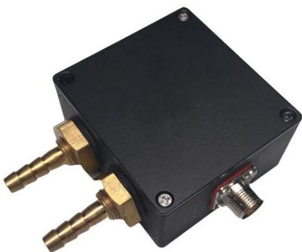
ASS-3 型高度空速传感器是用于测量无人机或直升机的气压高度和指示空速。该产品采用两个独立的高精度压力传感器分别测量静压和全压，选用高性能微处理器对检测信号进行分析、计算，并在全工作温度范围（-55℃～+70℃）内，对检测信号进行软件补偿。通过对大气压力和温度的测量，实时解算出飞行器的气压高度和指示空速，最终结果经过 RS422 接口输出。特点有数字式输出、精度高、适应温度范围宽、互换性强、年稳定性好、体积小、功耗低、抗潮湿、抗冲击、抗振动性能好。产品应用于汽车高度测量仪、直升机或无人机气压高度和指示空速测量、捷联惯导系统。
