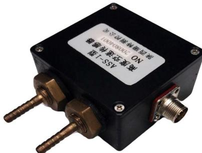
ASS-1 型高度空速传感器是用于测量飞行器的气压高度和指示空速。该产品采用两个独立的高精度压力传感器分别测量静压和全压，选用高性能微处理器对检测信号进行分析、计算，并在全工作温度范围（-55℃～+70℃）内，对检测信号进行软件补偿。通过对大气压力和温度的测量，实时解算出飞行器的气压高度和指示空速，最终结果经过 RS422 接口输出。产品具有数字式输出、精度高、适应温度范围宽、互换性强、年稳定性好、体积小、功耗低、抗潮湿、抗冲击、抗振动性能好的特点。主要应用于各种飞行器的气压高度和指示空速的测量、海拔高度测量仪器、捷联惯导系统。
